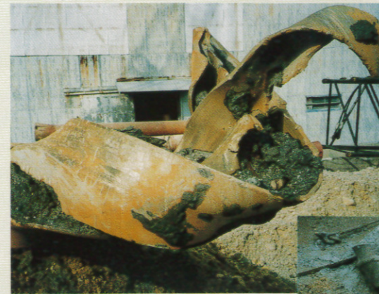
振り出されたH鋼杭▲
