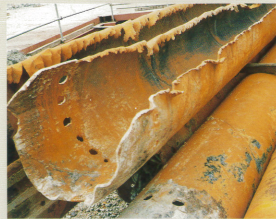
振り出された鋼管杭▶
