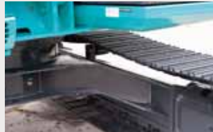
泥を落としやすい片流れタイプの クローラフレーム
