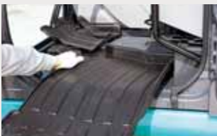
取り外ししやすい耳付2分割フロアマット 下にはフロア排水口を設置
